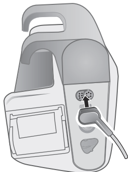
Abbildung 6-3 Anschließen des EKG-Kabels an das X Series Gerät
