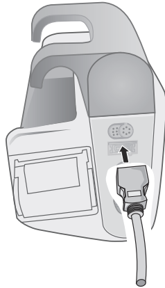
Abbildung 10-3 Anschließen des SpO 2 -Sensors an das X Series Gerät
