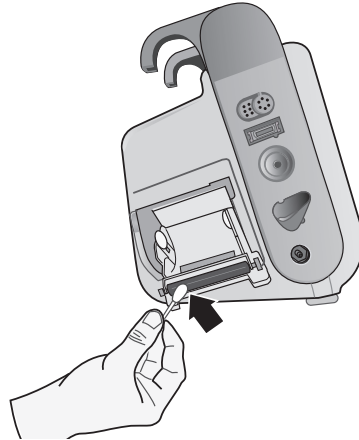
Abbildung 25-3. Reinigen des Druckkopfs
