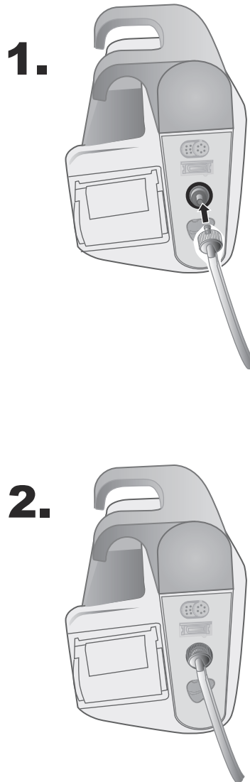
Abbildung 8-1 Anbringen eines Doppellumenschlauchs am X Series Gerät
